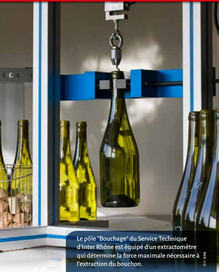
Le pôle "Bouchage" du Service Technique d'Inter Rhône est équipé d'un extractomètre qui détermine la force maximale nécessaire à l'extraction du bouchon.
