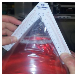
Mesure du cône d'air avec le BIB cône meter
