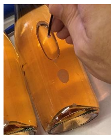
Mesures de l'oxygène dissous et gazeux contenus dans la bouteille
