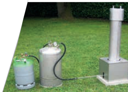
Diffuseur d'iode d'argent Source ANELFA.
