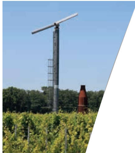
Brasseur d'air avec chauffage, région de Chinon en Val de Loire.
